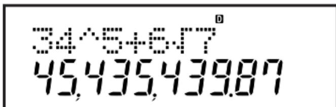
Das zweizeilige Display ermöglicht die gleichzeitige Anzeige der Berechnungsformel und des Ergebnisses.
